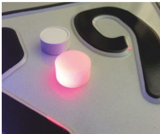
Un scanner UV fera s'allumer en rouge un verrou de sécurité d'origine.
