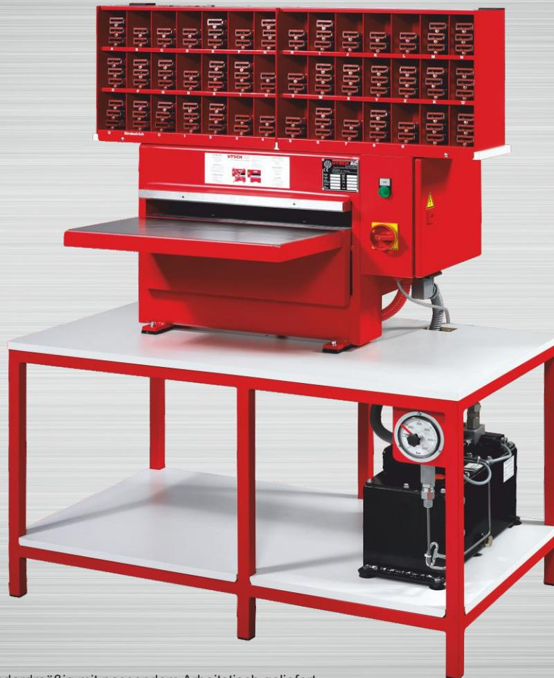
Die 250 kN Presse wird standardmäßig mit passendem Arbeitstisch geliefert.
