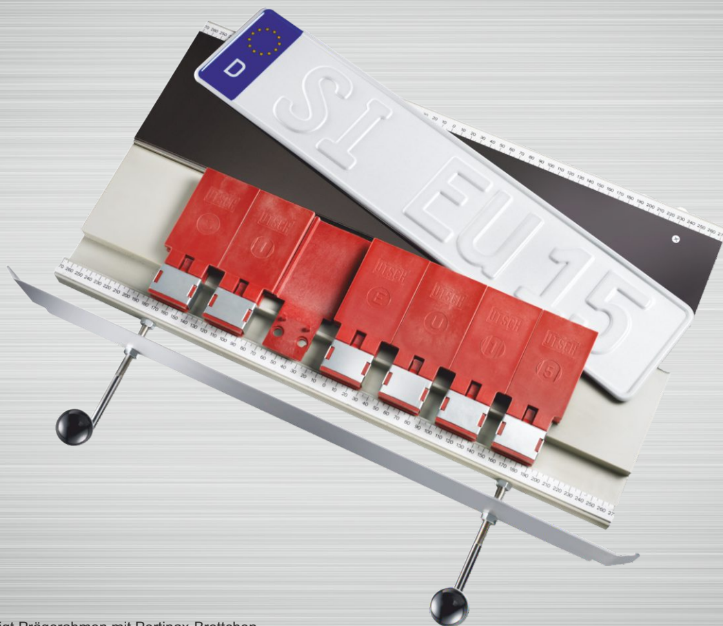
Abbildung zeigt Prägerahmen mit Pertinax-Brettchen zur Herstellung einzelner Kennzeichen.
