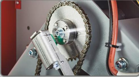
Sichere Drehüberwachung durch staubunempfindliche Magnete.
