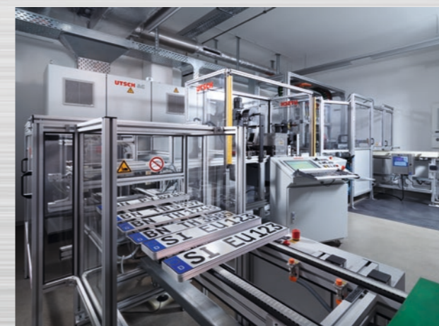
"Prensa de estampación automática": fabricación de grandes cantidades de matrículas de vehículos de forma asistida por ordenador y totalmente automatizada.
