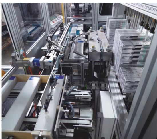
Darüber hinaus kann die Anlage modular um zusätzliche Prozessschritte wie z. B. eine Lasercodiereinrichtung, Qualitätskontrolle per Video oder automatischer Erstellung von Versandunterlagen erweitert werden.
