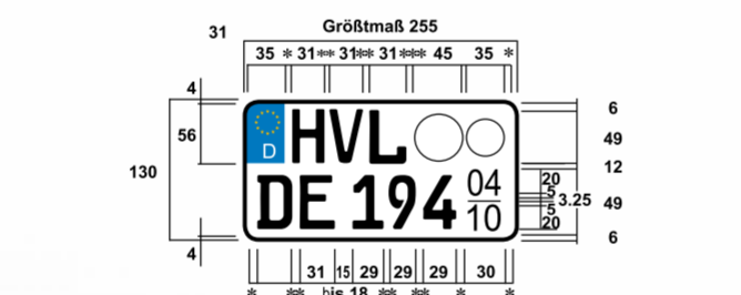
Zweizeiliges Saison-Kennzeichen, verkleinert FE-Schrift 49 mm, (Leichtkrafträder und Zugmaschinen) * Mindestmaß 6 mm ** 8 - 10 mm *** 5 - 20 mm
