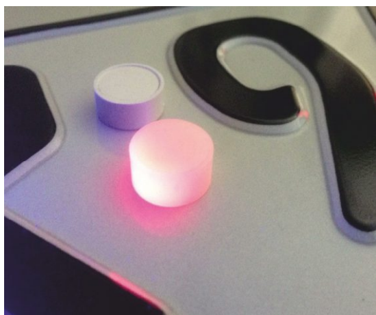
Un scanner UV fera s'allumer en rouge un verrou de sécurité d'origine.
