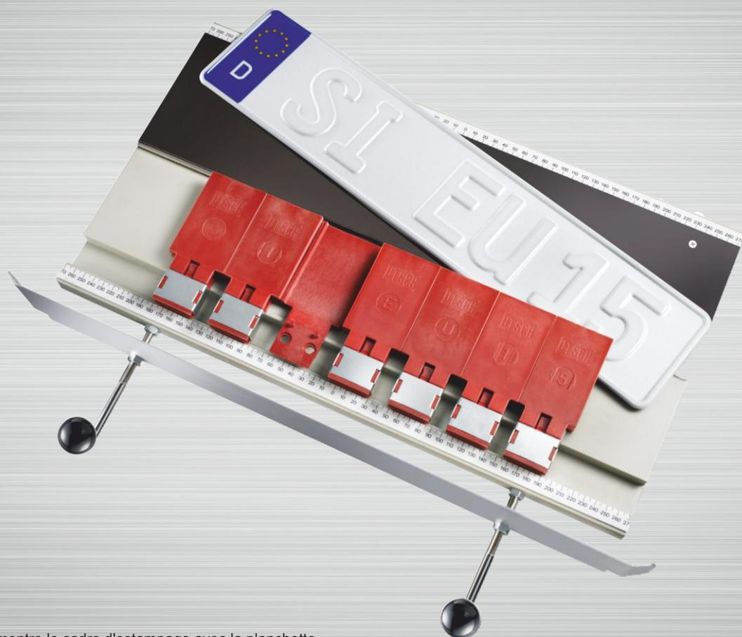
L'illustration montre le cadre d'estampage avec la planchette Pertinax pour la fabrication de plaques une ligne.
