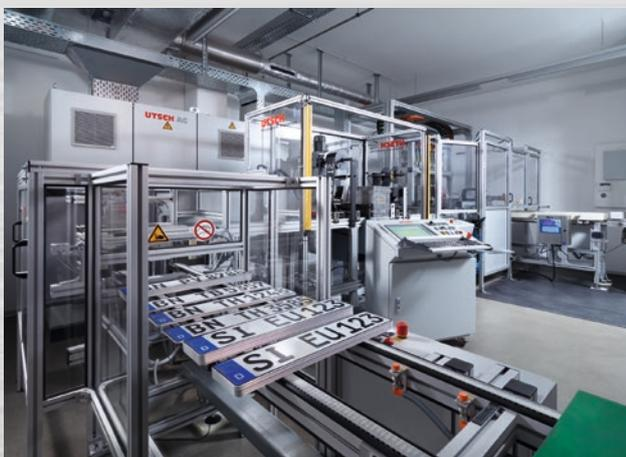
Die „Automatische Prägepresse“: computergesteuerte, vollautomatische Herstellung von Kfz-Kennzeichen in großen Stückzahlen.
